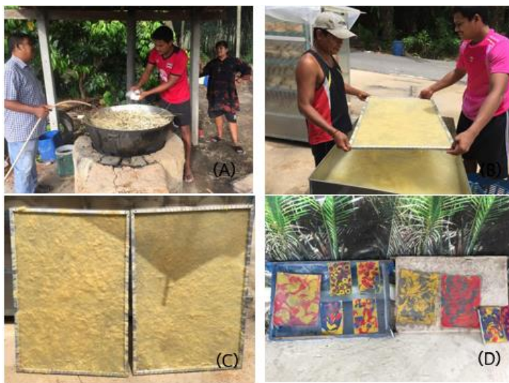
ภาพที่ 13 การถ่ายทอดเทคโนโลยีการผลิตกระดาษจากให้แก่ชุมชนลุ่มน้ำปะเหลียน (A) การเตรียมวัตถุดิบ (B) การเตรียมเยื่อกระดาษ (C) การขึ้นรูปกระดาษ และ (D) ผลิตภัณฑ์กระดาษ จาก
